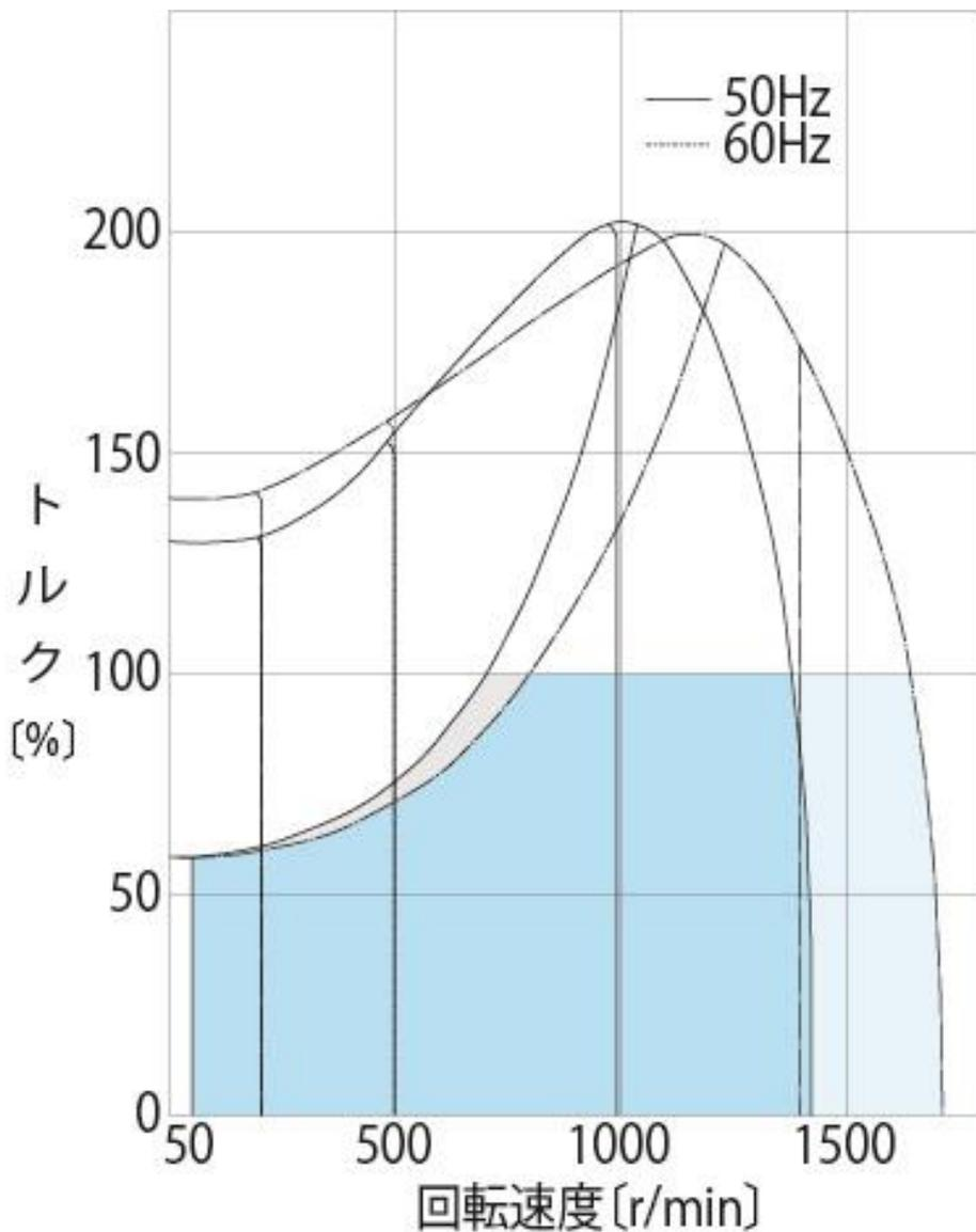
(注)トルク100%が、高速時許容トルクを表します。
